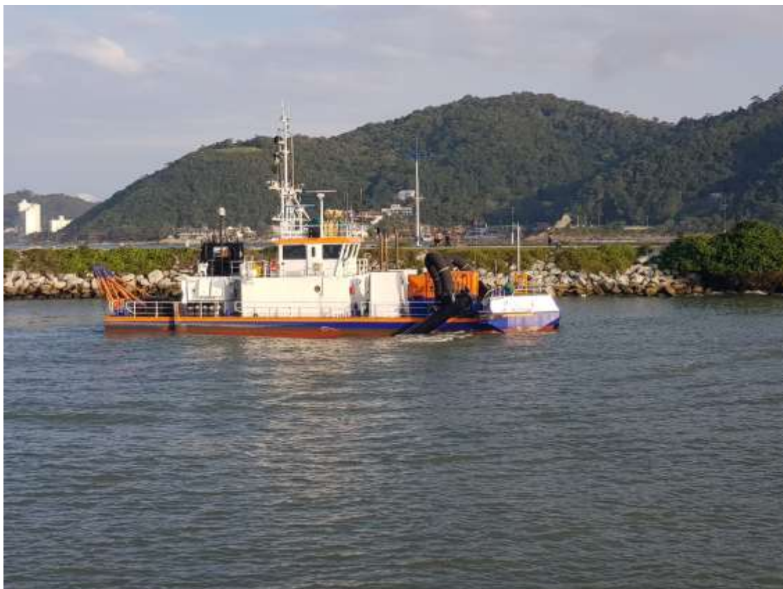
Figura 2: Draga Njörd, embarcação de dragagem de injeção de água. Dimensões: 34,7 x 11,67 metros, 1.644 kW de potência e profundidade máxima de dragagem de 21 metros.
