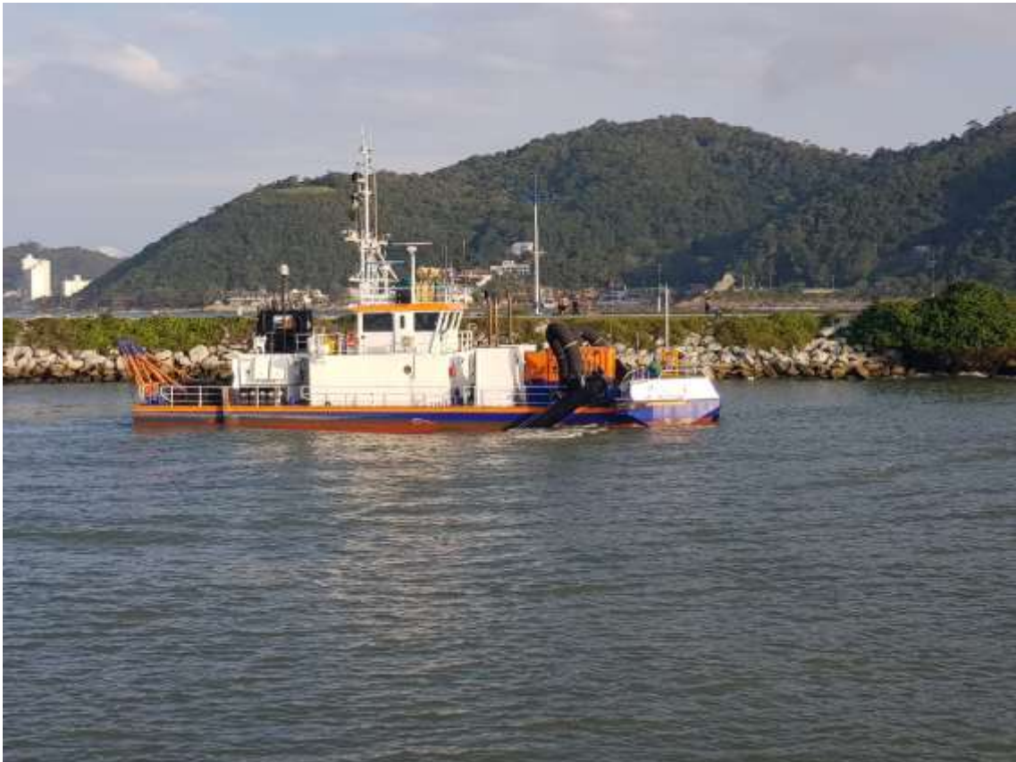
Figura 190: Draga Njörd, embarcação de dragagem de injeção de água. Dimensões: 34,7 x 11,67 metros, 1.644 kW de potência e profundidade máxima de dragagem de 21 metros.
