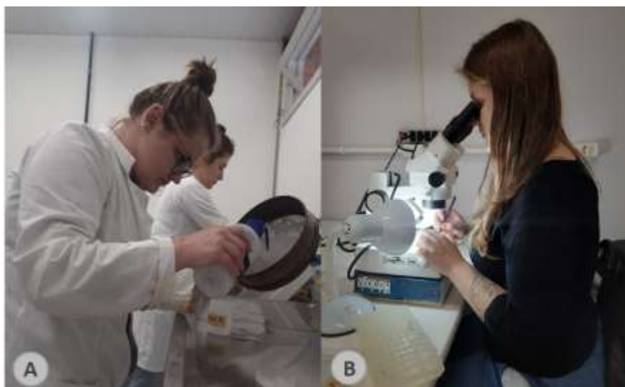
Figura 41: A) Lavagem das amostras da macrofauna bentônica em peneira de 500 \mu\text{m} . B) Identificação da macrofauna bentônica em microscópio estereoscópico.
