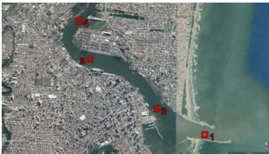
Figura 71: Localização das estações de coleta de dados de velocidades e direções de correntes, salinidade, temperatura e turbidez d'água no estuário do rio Itajaí-Açu. Fonte: Google Earth.
